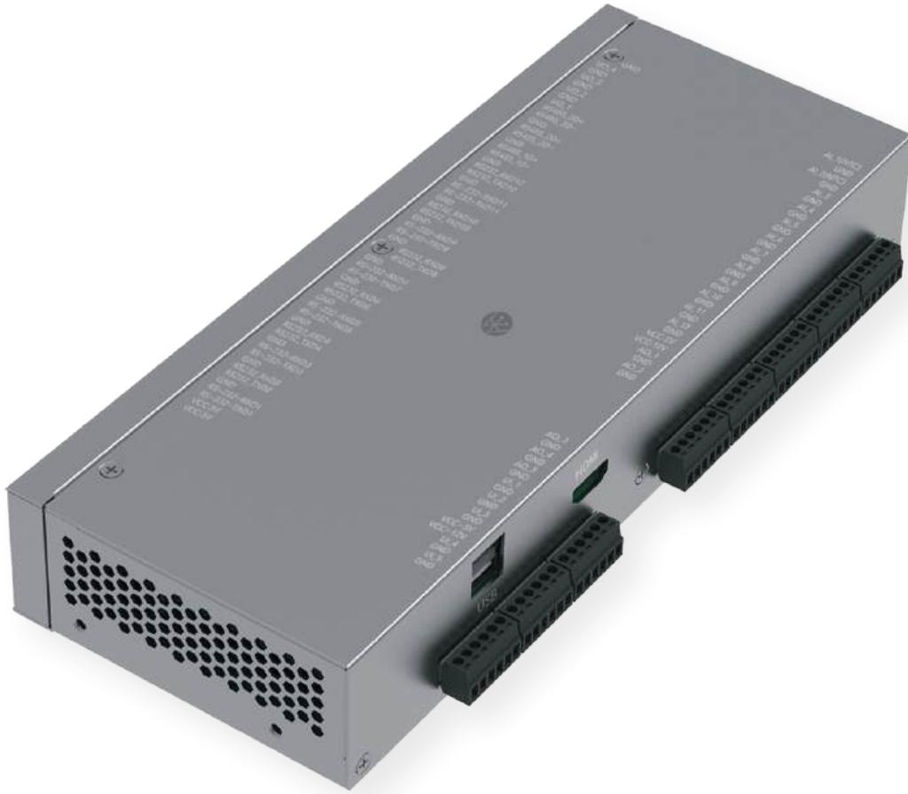
AU200属于Smart AHU系列产品，可配合各种不同型式的空调箱连结感测元件和控制元件，依据供回风运转资讯的水阀/风门/风机变频器进行各项回授控制。搭配前/后台操作系统，Web-based架构，让使用者藉由运转性能的可视化，预警盘管和滤网效率衰退，便于掌握设备运行状态。
